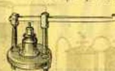
Soupape de sûreté à colonne cylindrique aspirant et bride ronde.
