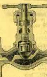
Robinet à soupape, coude verticale laissant voir le mouvement de fermeture.
